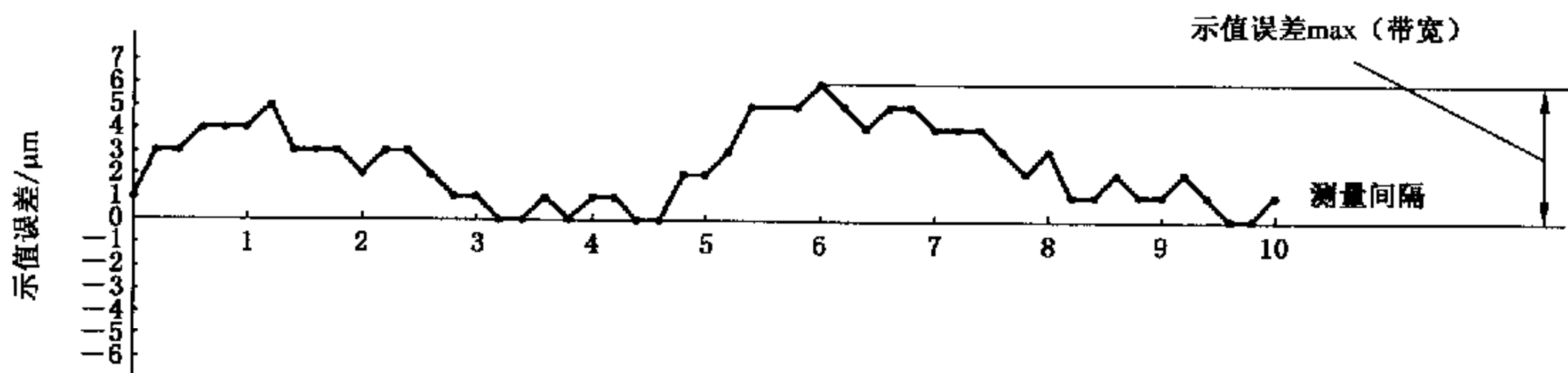
图 4 相对于浮动零位的示值误差(测量杆正行程曲线)示意图
