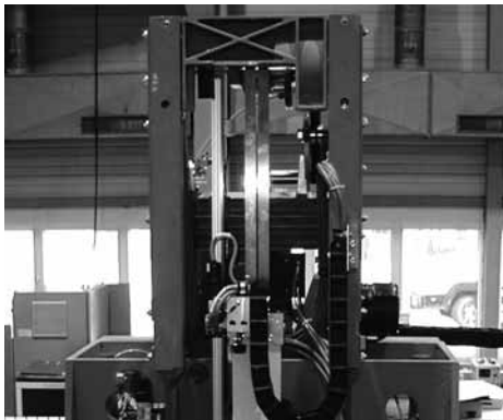
图 2.35 PMM-C 测量机的 Z 轴的电机 - 减速器平衡
