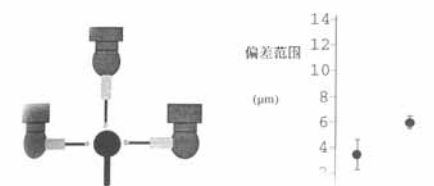
图 5.39 多探针或旋转测座测量误差
