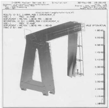
图 2.24 测量机桥架的有限元分析
