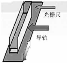
图 2.23 单端固定并安在导轨内的钢带式光栅
