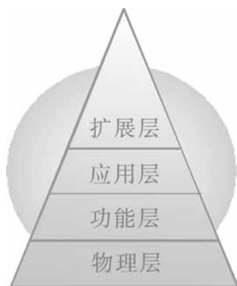
图 9.1 坐标测量发展的重层面 今天的坐标测量机技术已经是一门应用领域多,跨学科,技术性强的系统工程。它受到工业和科研对高精度,高效率,高可靠度,自动化,模块化,系统化,信息化,多能化,智能化,人性化,兼容性,可扩展性,低资源消耗的要求的持续推动;同时也得到了来自新材料,新工艺,能源技术,动力技术,传感技术,控制技术,数理工具,半导体技术,人体工程,现代信息技术,管理技术的有力支持。在这些因素的驱动下,当今坐标测量发展的重要方向可以分成不同的层面(如图 9.1):物理层,功能层,应用层和扩展层。下面,本章节就按照层面的顺序来介绍一下坐标测量的发展方向。
