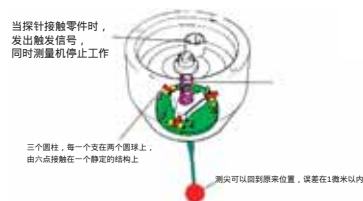
图 5.1 触发测头基本结构
