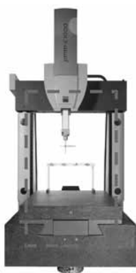
图 2.17 固定桥式形成封闭框架
