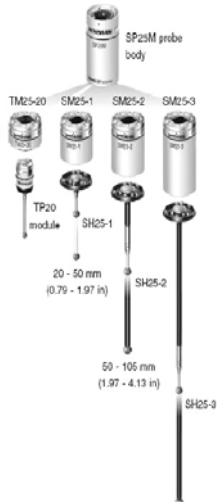
图 5.14 SP25接触式扫描测头
