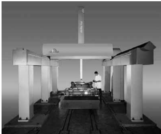
图 8.16 大型、超大型工件的测量
