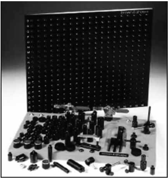
图 8.4. 简单实用的SWIFTFIX通用夹具系统
