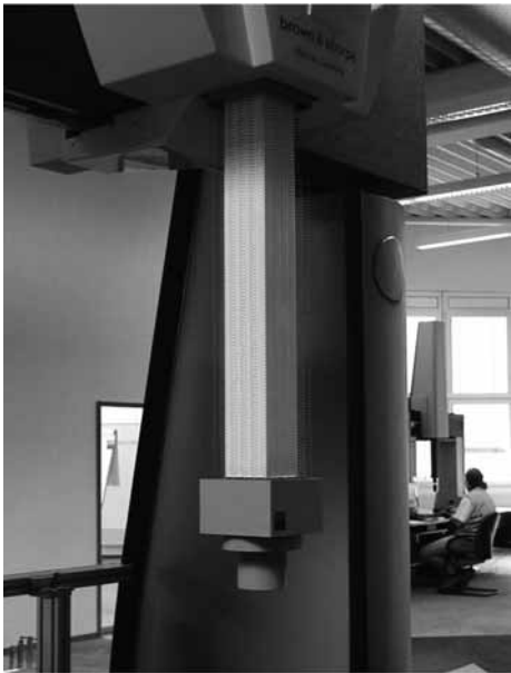
德国 LEITZ 公司的 PMM-C 固定桥式测量机采用陶瓷 Z 轴
