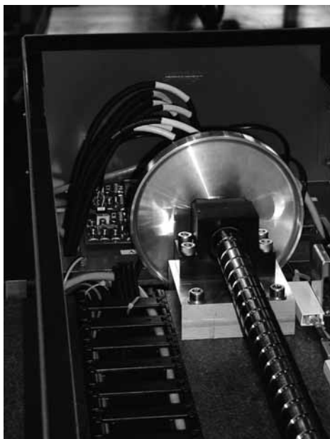
图 2.31 PMM-C的滚珠丝杠传动
