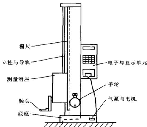
图1 数显测高仪结构示意图
