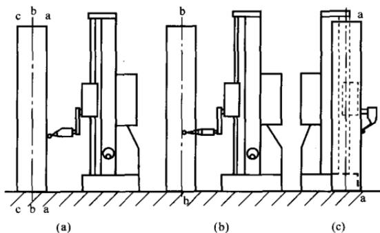
图2 仪器正面、侧面垂直度的检测
